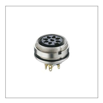
Einbaukupplung nach AISG-Spezifikation und IEC 61076-2-106, IP68, mit Schraubverschluss und Lötanschlüssen, für Rückseitenmontage
