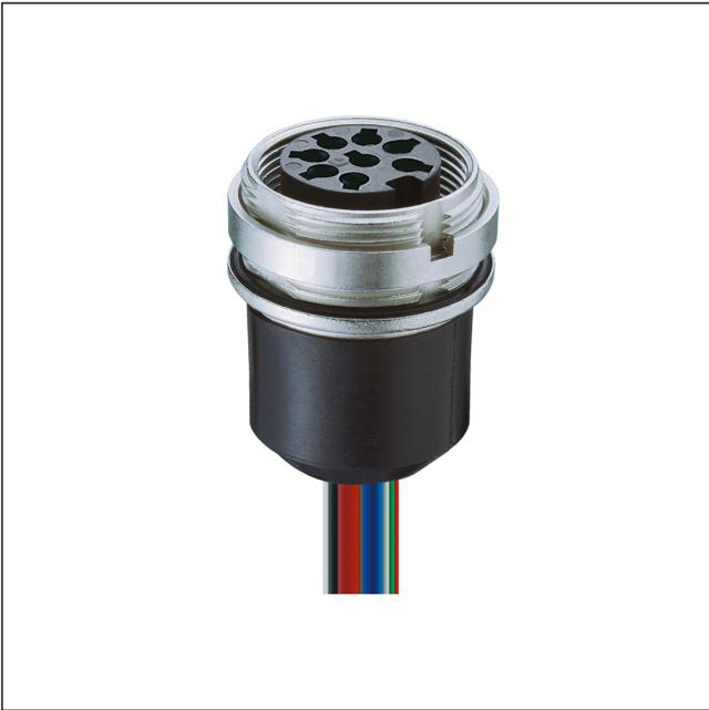
Einbaukupplung nach IEC 61076-2-106 und AISG-Spezifikation, IP68, mit Schraubverschluss, mit Kabelkonfektioniert und im Lötbereich vergossen, für Rückseitenmontage
