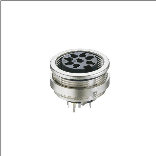
Einbaukupplung nach AISG-Spezifikation und IEC 61076-2-106, IP68, mit Schraubverschluss, für Leiterplatten, für Frontmontage
