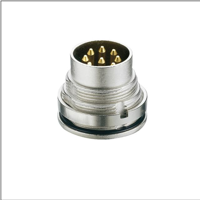
Einbaustecker nach AISG-Spezifikation und IEC 61076-2-106, IP68, mit Schraubverschluss und Lötanschlüssen, für Rückseitenmontage
