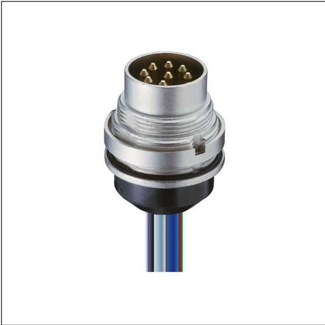
Einbaustecker nach IEC 61076-2-106 und AISG-Spezifikation, IP68, mit Schraubverschluss, mit Kabelkonfektioniert und im Lötbereich vergossen, für Rückseitenmontage
