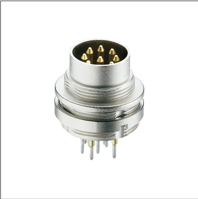
SWUM™-Einbaustecker nach IEC 61076-2-106 und AISG-Spezifikation, IP68/67, mit Schraubverschluss, für Leiterplatten, manuelle Lötung, für Frontmontage
