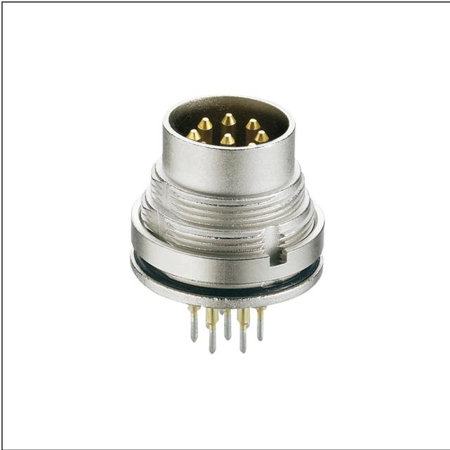
SWUM™-Einbaustecker nach IEC 61076-2-106 und AISG-Spezifikation, IP68/67, mit Schraubverschluss, für Leiterplatten, manuelle Lötung, für Rückseitenmontage
