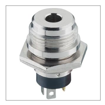
Klinkeneinbaukupplung nach JIS C 6560 JC35J3A, 3,5 mm, 3-polig/stereo, mit Schraubverschluss, mit Lötaugen, für Frontmontage
