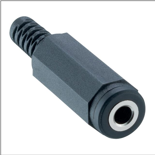
Klinkenkupplung nach JIS C 6560 JC35J2A, 3,5 mm, 2-polig/mono, gerade Ausführung, mit Knickschutz und Lötanschlüssen
