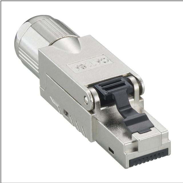
Modularstecker, Cat. 6a, 8p8c (RJ45), gerade Ausführung, mit geschützter Verriegelungslasche und Schirmung, werkzeuglos anschließbar in Schneidklemmtechnik (SKT)
