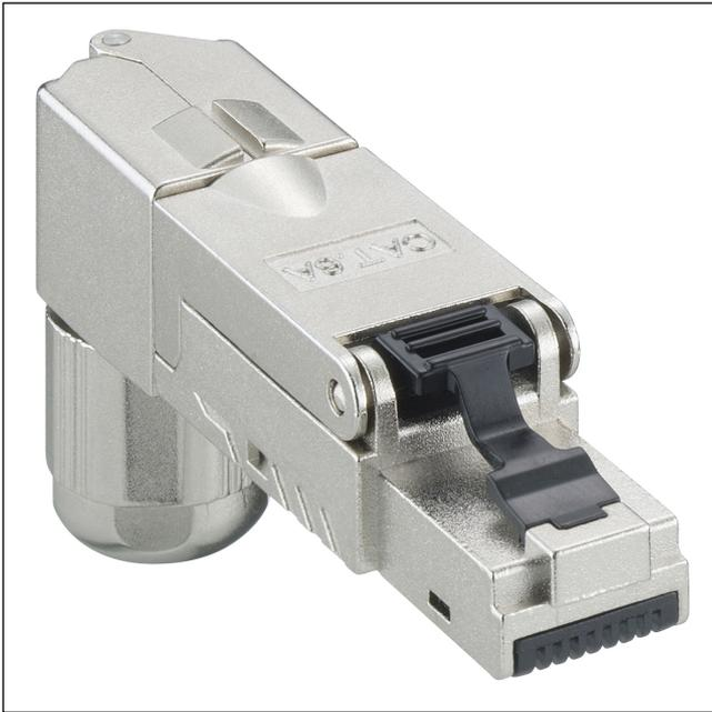
Modularstecker, Cat. 6a, 8p8c (RJ45), abgewinkelte Ausführung (verdrehbar), mit geschützter Verriegelungslasche und Schirmung, werkzeuglos anschließbar in Schneidklemmtechnik (SKT)
