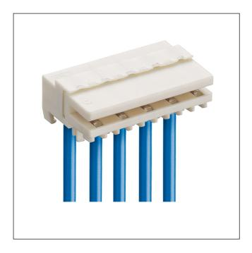
RAST-2.5-Power-Steckverbinder für direktes und indirektes Stecken, in Schneidklemmtechnik (SKT), teilungsgerecht anreihbar Kontaktraster 5,0 mm
