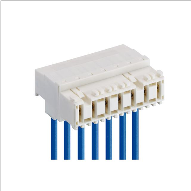
RAST-5-Steckverbinder für indirektes Stecken, mit Schraubanschluss, mit Fahrstuhlklemmkörper mit Untersteckschutz, mit Prüfabgriff und Innenverrastung, ohne Teilungsverlust anreihbar, Kabelabgang gegenüber der Verrastung
