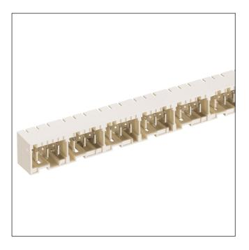
RAST-5-Messerleiste, abgewinkelt, mit untenliegender Verriegelung, frei konfigurierbar mit Zwischenwänden
