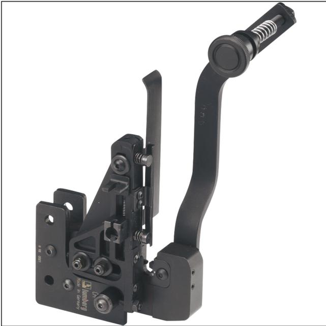
Crimp-Werkzeugmodul für Minimodul™-/Multimodul™-
