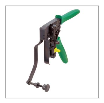
Handzange für das Anschlagen von Minimodul™-/ Multimodul™- Crimpkontakten
