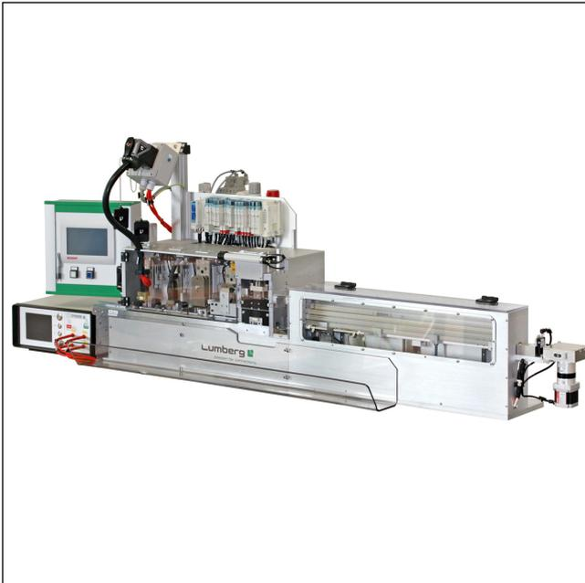
Halbautomatische Verarbeitungsmaschine für das Anschlagen von RAST-1.5-Steckverbindern in Schneidklemmtechnik (SKT), größere Basismaschine, mit integrierten Stationen für Leiterfarbprüfung, Kodierschneiden, Kodierprüfen und Hochspannungstest
