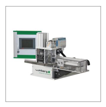
Halbautomatische Verarbeitungsmaschine für das Anschlagen von RAST-2.5-Power-plus™-Steckverbindern in Schneidklemmtechnik (SKT), mit integrierter Leiterfarbprüfung
