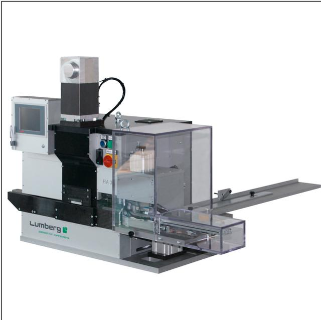
Halbautomatische Verarbeitungsmaschine für das Anschlagen von RAST-2.5-Steckverbindern in Schneidklemmtechnik (SKT), mit integrierter Leiterfarbprüfung
