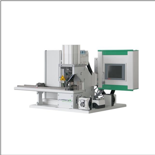
Halbautomatische Verarbeitungsmaschine für das Anschlagen von RAST-2.5-Steckverbindern in Schneidklemmtechnik (SKT), zur Fertigung von Busleitungen (Daisy Chain), auf die Anwendungsbedürfnisse anzupassende Maschine
