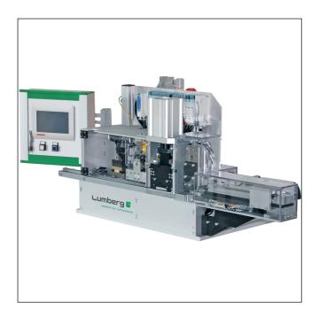
Halbautomatische Verarbeitungsmaschine für das Anschlagen von RAST-2.5-Steckverbindern in Schneidklemmtechnik (SKT), größere Basismaschine, mit integrierten Stationen für Kodierschneiden und Kodierprüfen, individuell nachrüstbar
