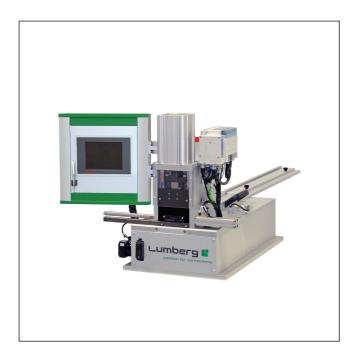
Halbautomatische Verarbeitungsmaschine für das Anschlagen von RAST-5-Steckverbindern in Schneidklemmtechnik (SKT), mit integrierter Leiterfarbprüfung
