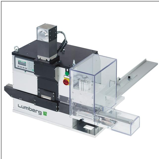
Halbautomatische Verarbeitungsmaschine für das Anschlagen von steckbaren Anschlussklemmen in Schneidklemmtechnik (SKT)
