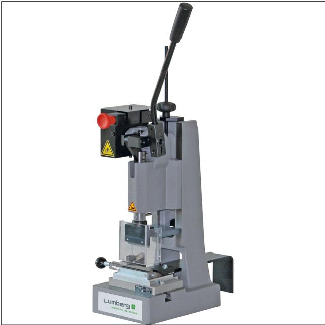
Kniehebelpresse für das Anschlagen von RAST-2.5-Steckverbindern in Schneidklemmtechnik (SKT)
