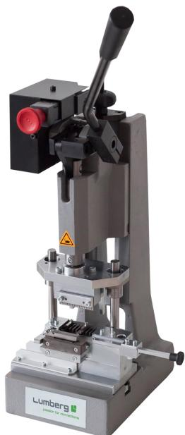
Kniehebelpresse für das Anschlagen von RAST-2.5-Power-plus™-Steckverbindern in Schneidklemmtechnik (SKT)
