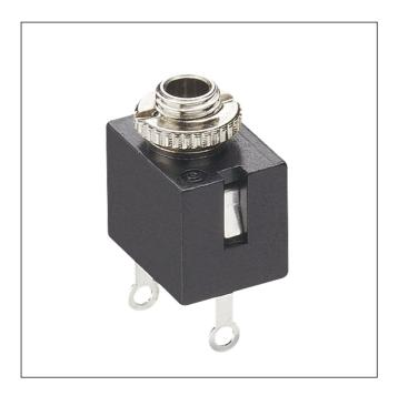
Klinkeneinbaukupplung nach JIS C 6560 JC25P2B, 2,5 mm, 2-polig/mono, mit Öffner und Lötaugen, für Rückseitenmontage
