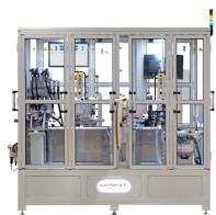
Vollautomatische Verarbeitungsmaschine für das Anschlagen von Micromodul™-Steckverbindern in Schneidklemmtechnik (SKT)
