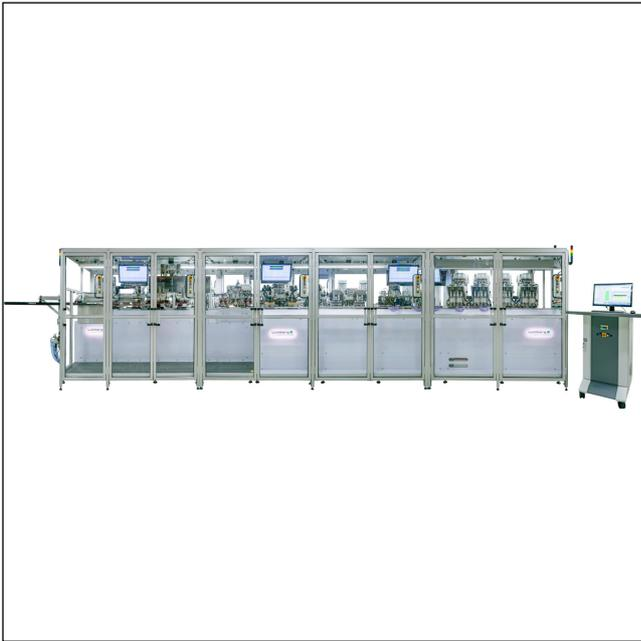
Flexible, vollautomatische Verarbeitungsmaschine für das Anschlagen von RAST-Steckverbindern in Schneidklemmtechnik (SKT), für vielfältige Kabelbaumkonfigurationen
